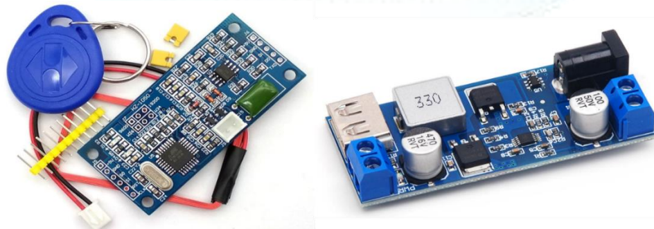
Şekil 6: RFID kart okuyucu modülü ve Regülatör Modülü
